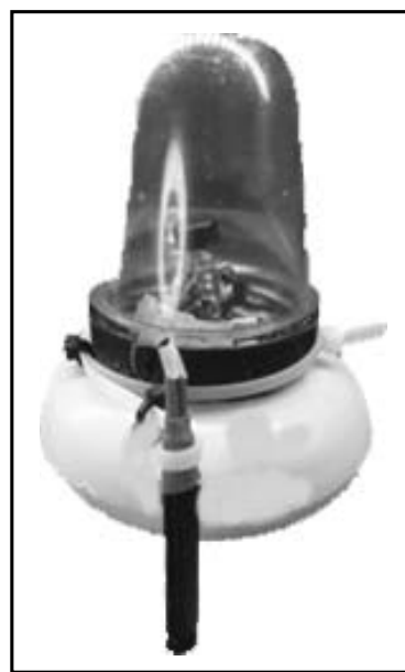
Рис. 8. Экспериментальные образцы поплавковых сенсоров обнаружения разливов нефтепродуктов на воде
