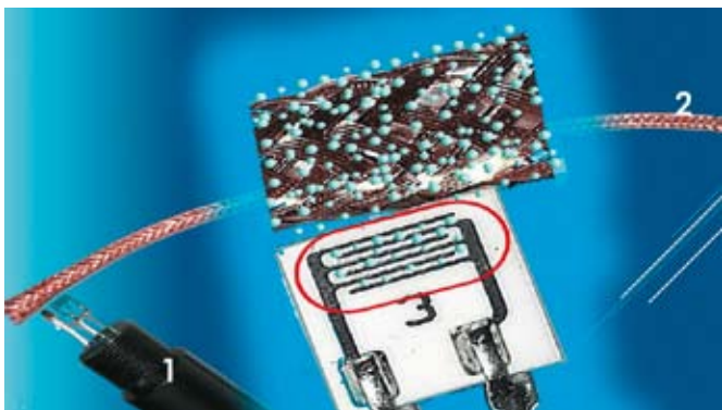
Рис. 2. Сравнение характеристик традиционных сенсоров влажности и кабельных сенсоров влажности: 1 – стандартный точечный сенсор влажности; 2 – кабельный сенсор влажности
